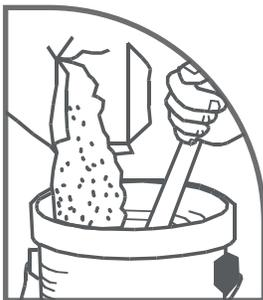
En 7.5 a 8.5 litros de agua agregue gradualmente un saco de 40 kg de Cemix Repello Gris y mezcle hasta obtener una pasta suave y libre de grumos. Espere 10 minutos antes de usar la mezcla. Sin agregar más agua vuelva a mezclar para usar.
