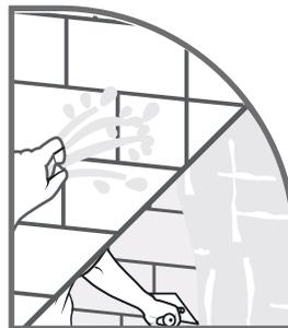
Humedecer la superficie donde se vaya a colocar la pasta de Cemix Repello Fino. Con una llana metálica cuadrada esparcir el material con movimientos hacia arriba y de izquierda a derecha formando una cruz.
